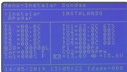
Aguarde até que o valor de todas as sondas apareça na tela. Após instalado, pressione OK novamente na opção “INSTALAR” para testar as sondas. Na tela aparecerá “TESTANDO”, aguarde a mensagem “AJUSTES SALVOS”.
