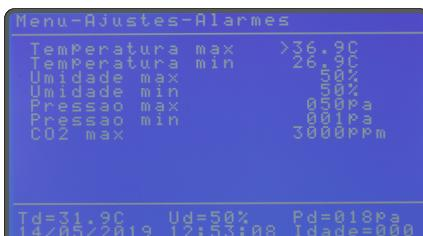
**Temperatura máxima:** Se o valor deste parâmetro não for ajustado manualmente pelo usuário, automaticamente, o controlador ajustará o valor deste parâmetro para 5 °C acima da temperatura desejada/ponto da curva.
