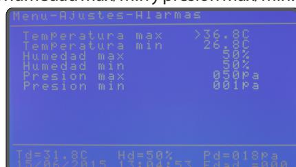
**Temperatura máxima:** si el usuario no ajusta manualmente el valor de este parámetro, el controlador ajustará automáticamente este valor a 5 °C por encima de la temperatura/punto de curva deseada. Cambie al valor deseado usando el teclado numérico.
