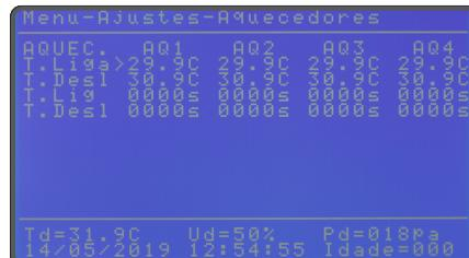
> **T. Liga/Desl:** temperatura que liga e desliga os aquecedores.
