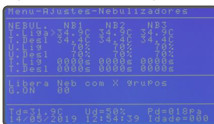
Função temperatura: liga caso a temperatura selecionada chegar no valor programado para ligar (T.Liga), e desliga se chegar a temperatura no valor programado para desligar (T.Desl) ou se a umidade atingir U.Desl.
