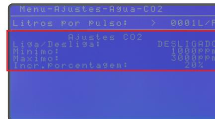
O controlador opera por ventilação mínima normalmente, usando os valores ajustados para Liga e Desliga no ciclo dos exaustores. Porém, se o nível de CO2 atingir CO2 Mínimo, o controlador irá aumentar o ciclo Liga e reduzir o ciclo Desliga da ventilação mínima em ciclos, para aumentar a ventilação e reduzir os níveis de CO2.
