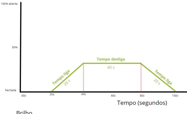
O controlador usará o Tempo liga para abrir ou fechar as cortinas (abrem se precisar ventilar e fecham para diminuir a ventilação). E usa Tempo desliga para estabilizar a temperatura através da parada das cortinas.
