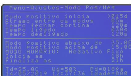
**1º** O usuário deve ajustar quando deseja realizar a transição, quanto tempo dura o intervalo de transição e ajustar os parâmetros para funcionamento das cortinas (não é possível configurar as cortinas individualmente).
