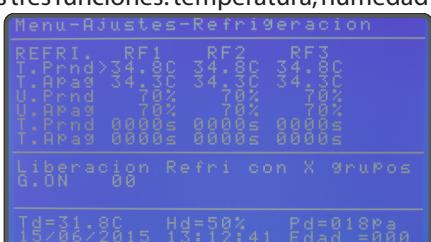
> Función temperatura: se enciende si la temperatura seleccionada alcanza el valor programado para el encendido (T.Prend), y se apaga si la temperatura alcanza el valor programado para el apagado (T.Apag) o se la humedad alcanza U.Apag.
