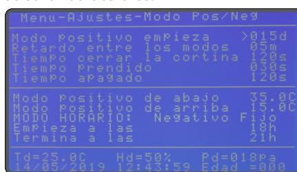
**1º** El usuario debe ajustar cuándo quiere realizar la transición, cuánto tiempo dura el intervalo de transición y ajustar los parámetros para el funcionamiento de las cortinas (no es posible configurar las cortinas individualmente).
