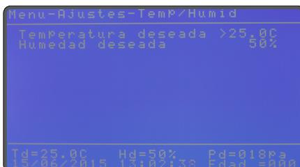
Para cambiar los valores de temperatura o humedad, escriba el valor deseado, usando el teclado numérico, y presione OK para guardar o MENÚ/SALIR para salir sin guardar.
