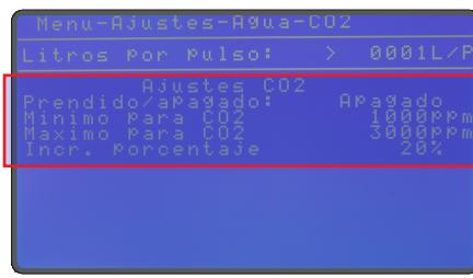
Normalmente, el controlador funciona con ventilación mínima, utilizando los valores establecidos para ON y OFF en el ciclo de los extractores. Sin embargo, si el nivel de CO2 alcanza el CO2 mínimo, el controlador aumentará el ciclo de encendido y reducirá el ciclo de apagado de la ventilación mínima en ciclos, para aumentar la ventilación y reducir los niveles de CO2.
