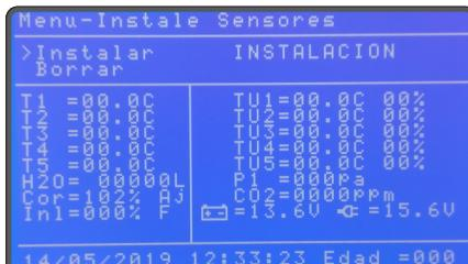
Espere hasta que aparezcan en pantalla los valores de todas las sondas. Una vez instalado, presione OK nuevamente en la opción "**INSTALAR**" para probar las sondas. En la pantalla aparecerá "**PROBANDO**", espere hasta ver el mensaje "**AJUSTES GUARDADOS**".
