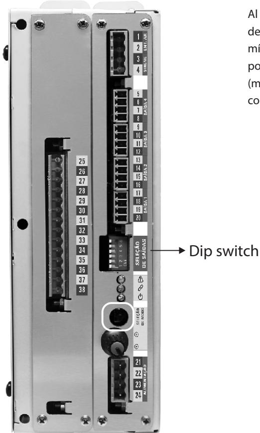
Al variar el potenciómetro se puede acelerar o desacelerar los ventiladores desde la velocidad mínima establecida hasta la máxima. También se podrá apagar (moviendo hacia abajo) o encender (moviendo hacia arriba) una salida a través del correspondiente interruptor *dip switch*.
