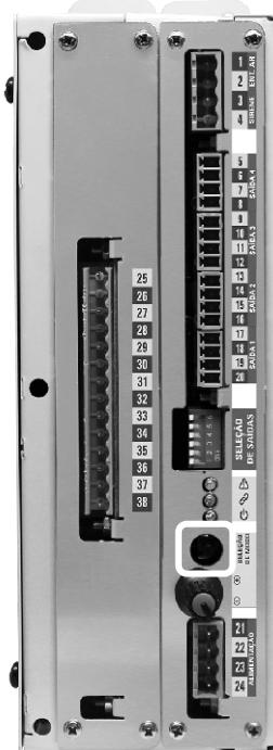
Nesse modo os LED azul e vermelho permanecem desligados, exceto quando há um erro de comunicação nas saídas, neste caso o LED azul pisca o valor de ID da sonda que está com erro, levando em consideração o valor de saída mais alta com erro, e o LED vermelho fica ligado direto.
