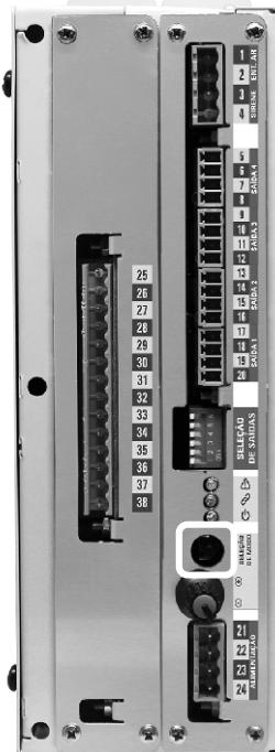
En este modo, los LED azul y rojo permanecen apagados, excepto cuando ocurre un error de comunicación en las salidas. En este caso, el LED azul parpadea el valor de ID de la sonda que presenta error, tomando en cuenta el valor de salida más alto con error, y el LED rojo permanece encendido continuamente.
