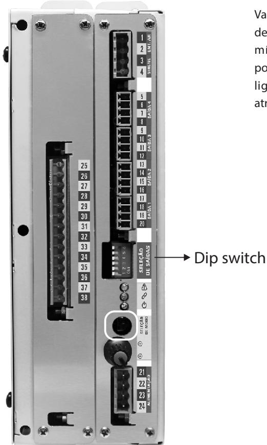
Variando o potenciômetro, é possível acelerar ou desacelerar os ventiladores desde a velocidade mínima ajustada até a máxima. Também é possível desligar (movimentando para baixo) ou ligar (movimentando para cima) uma saída, através da chave *dip switch* correspondente.
