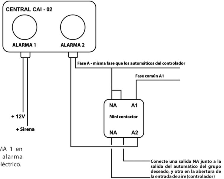
**OBS.:** Conecte la ALARMA 1 en forma paralela con la alarma convencional del tablero eléctrico.
