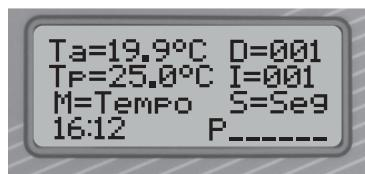
**T<sub>A</sub>** - Temperatura da água;
