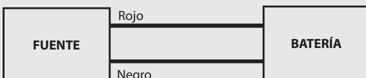
**Figura 3:** Conexión de la Batería.
