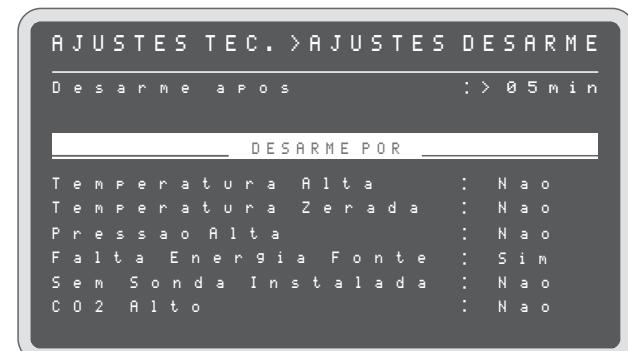
**Obs.:** No ajuste de fábrica o controlador sai habilitado para desarmar somente por alarme de falta de energia fonte.
