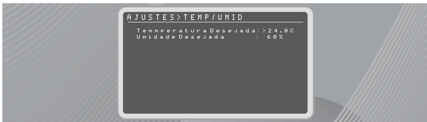
Caso o controlador **SMAAI 5** tenha sido configurado no menu **Ajustes Técnicos** -> **Modos de Controle** para operar por curva, é necessário realizar os ajustes de temperatura, umidade e GRM desejados para até 10 pontos.
