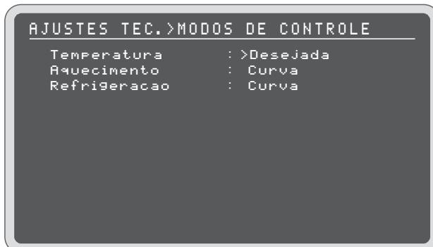
**Obs.:** As configurações de operação para o modo DESEJADA ou CURVA, devem ser ajustadas no menu de Ajustes para as três opções separadamente: Temperatura/Umidade, Refrigeração, Aquecimento.
