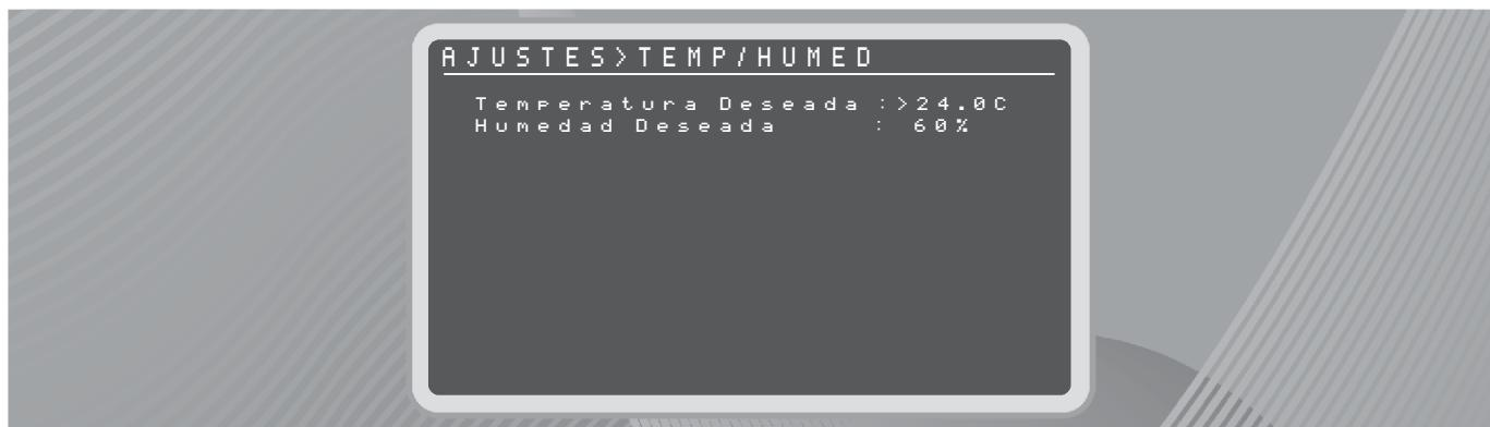
Si el controlador **SMAAI 5** se configuró en el menú **Ajustes Técnicos -> Modos de Control** para operar por curva, es necesario realizar los ajustes de temperatura, humedad y GRM deseados en hasta 10 puntos.
