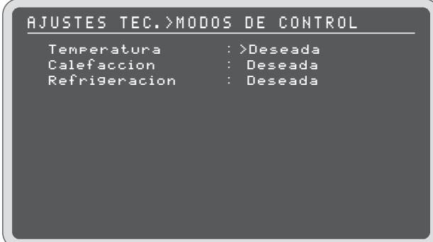
**Obs.:** Las configuraciones de operación para el modo DESEADA o CURVA deben ajustarse por separado en el menú de Ajustes para las tres opciones: Temperatura/Humedad, Refrigeración, Calefacción.
