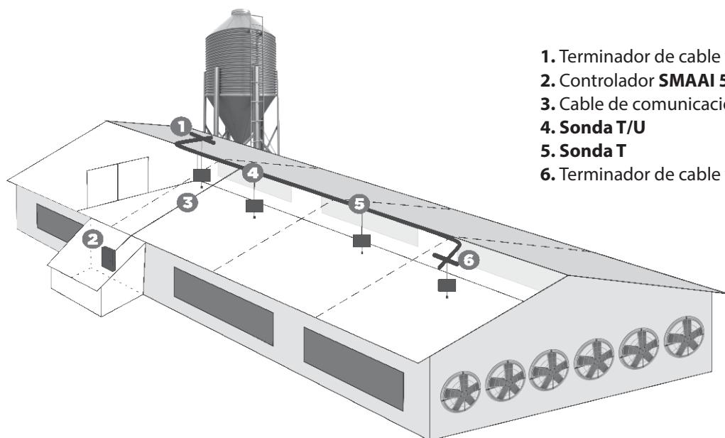
\* Imagen ilustrativa: realice la instalación de los terminadores según la configuración de su galpón.
