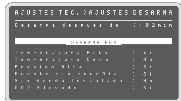
**Obs.:** En el ajuste de fábrica, el controlador solo está habilitado para desarmar por alarma de falta de energía fuente.
