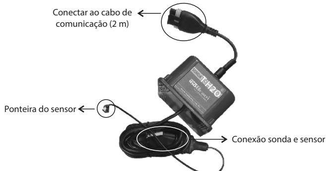
Para instalar o sensor da **Sonda T-H<sub>2</sub>O** no cano de água da granja, fure o cano com uma broca 6,5 mm (sugere-se instalar o sensor o mais próximo possível da última saída de água).
