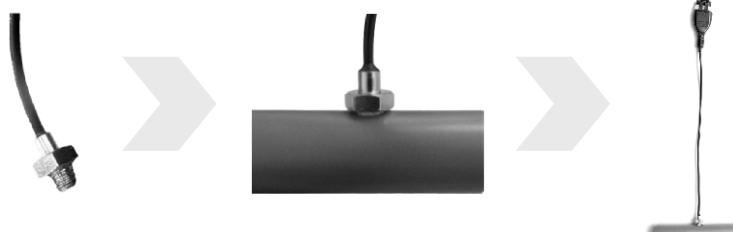
**Observación:** Si es necesario, utilice cinta para sellar roscas después de fijar el sensor. Aplique solamente en la región de la rosca del tornillo.
