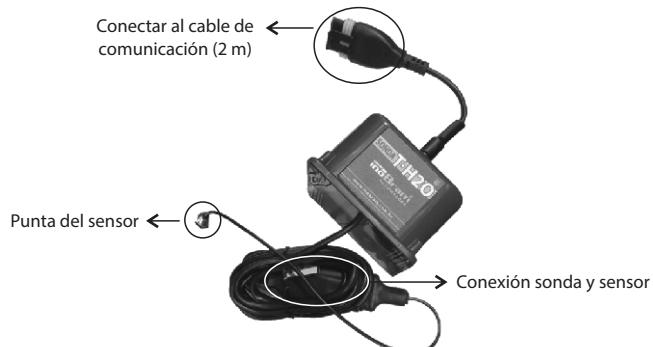
Para instalar el sensor de la **Sonda T-H2O** en el caño de agua de la granja, perfore el caño con un taladro de 6,5 mm (se recomienda instalar el sensor lo más cerca posible de la última salida de agua).
