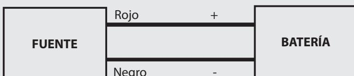
**Figura 3:** Conexión de la Batería.
